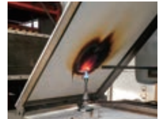
延焼性試験状況
