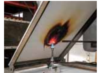
延焼性試験状況
