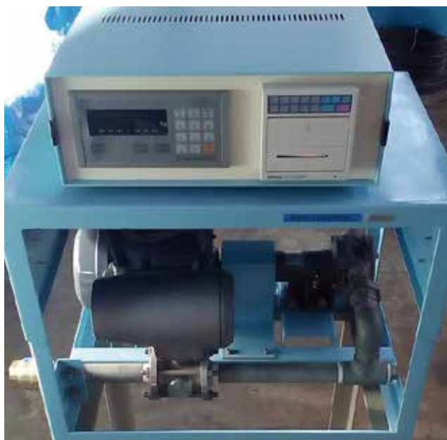
(上) 印字記録計 (下) ポンプ本体
