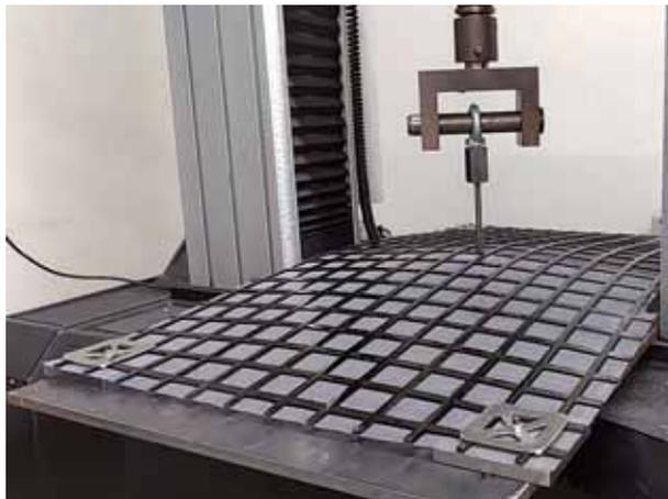
引き抜き試験状況( HM-C22 ) 固定ピッチ : 900 × 500 mm
