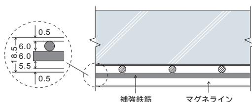
覆工コンクリートを補強する場合は、鉄筋または格子鉄筋にて補強します。また、断面修復やはく落防止には溶接金網やメッシュシートを設置し補修します。
