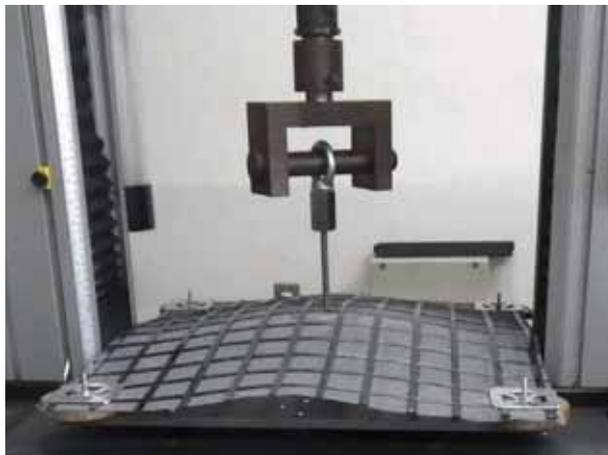
引き抜き試験状況( HM-C11 ) 固定ピッチ : 500 × 500 mm
